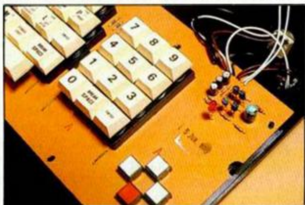
El teclado anterior no tenía el amplificador integrado y el circuito impreso era de bakelita.
